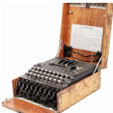
3. Ábra: Az Enigma – német gyártmányú, forgótárcsás, elektromechanikus berendezés, amelyet a II. Világháború alatt használtak a németek. [17]
