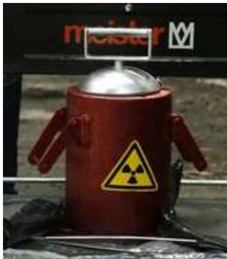
7. ábra: Automata robotkar a céltárgyak elhelyezésére és kivételére a besugárzó kamránál, valamint árnyékolással ellátott szállító konténer [saját szerkesztés]
