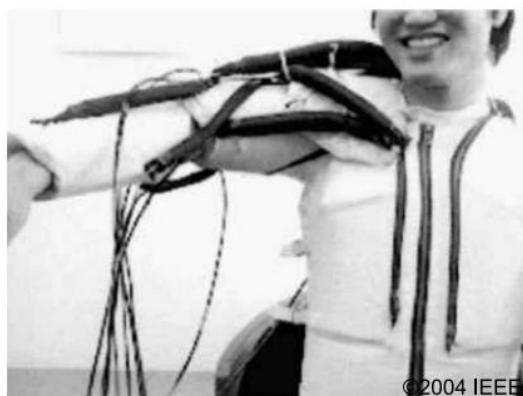
2. Ábra: McKibben féle PAM-ok hálózatából álló exoskeleton [18]
