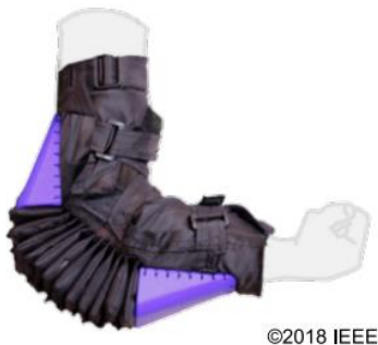
5. Ábra: FEA alapú könyök mozgására alkalmas exoskeleton [23]
