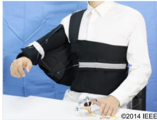
3. Ábra: Étel szájba juttatásának mozgatsorait segítő hibrid exoskeleton [19]
