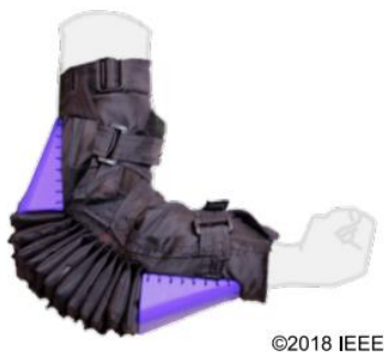
5. Ábra: FEA alapú könyök mozgására alkalmas exoskeleton [23]
