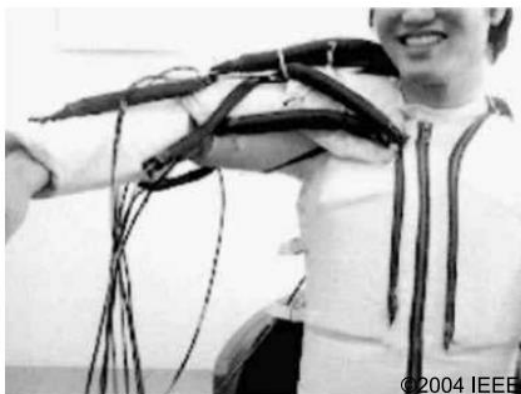
2. Ábra: McKibben féle PAM-ok hálózatából álló exoskeleton [18]
