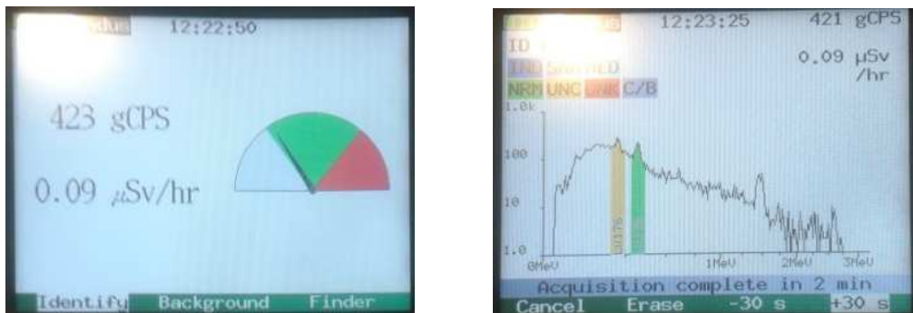
10. ábra: Gamma dózisteljesítmény mérés (bal oldali ábra), spektrum analízis (jobb oldali ábra) RIIDEye-G készülékkel [saját szerkesztés]
