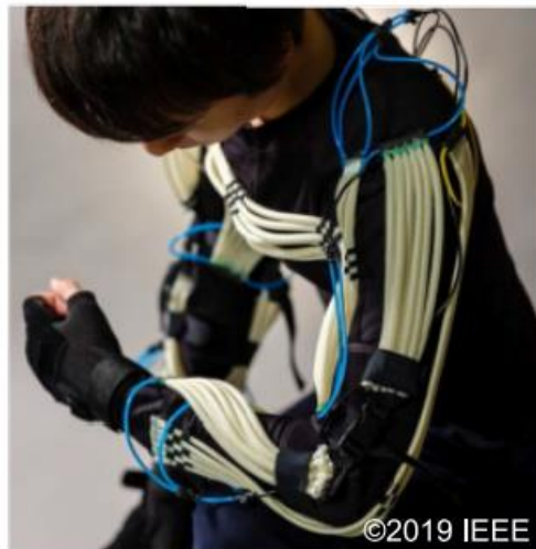
4. Ábra: Miniatűr McKibben aktuátorok hálózatával megvalósított exoskeleton [21]
