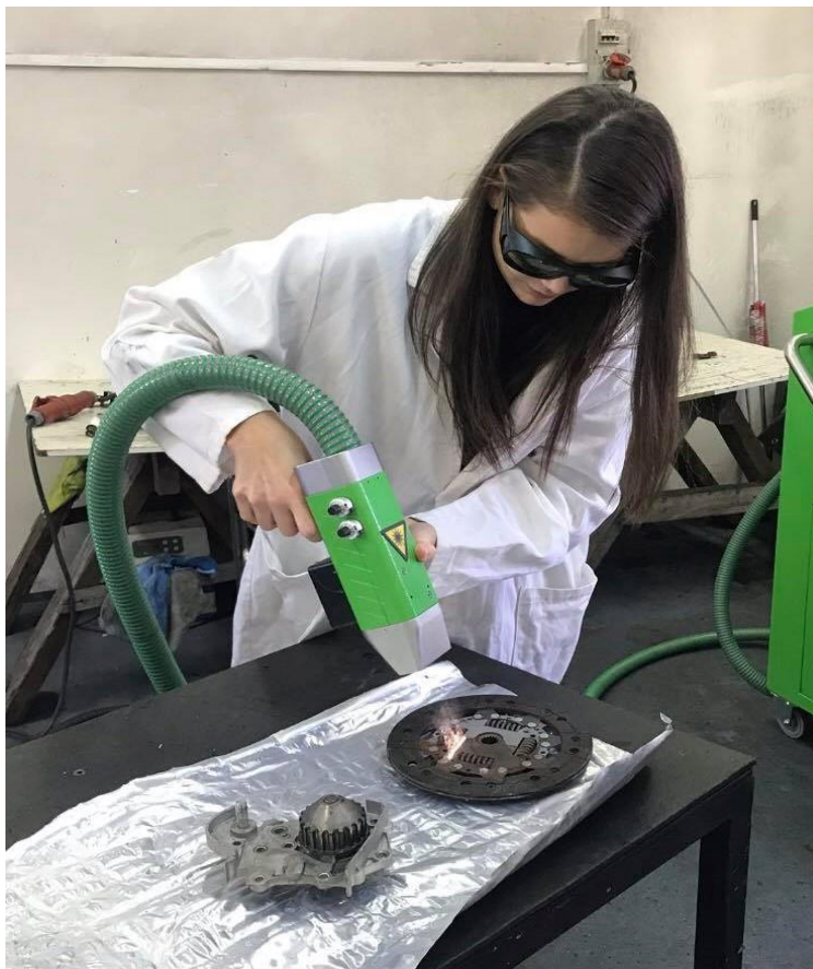
12. ábra: Lézerrel tisztított autóalkatrészek, inaktív minták, [3]
