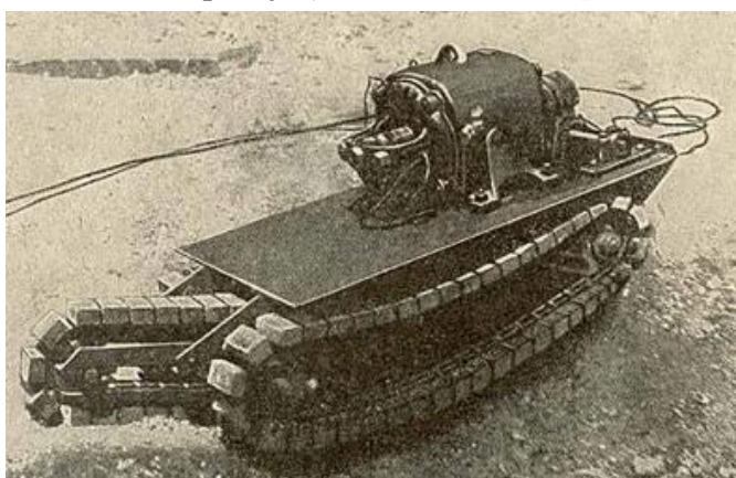
4. Ábra: Aubriot-Gabet Torpille Electrique kísérleti modell, forrás: https://en.topwar.ru/123927-suhoputnaya-torpeda-aubriot-gabet-torpille-electrique-franciya.html
