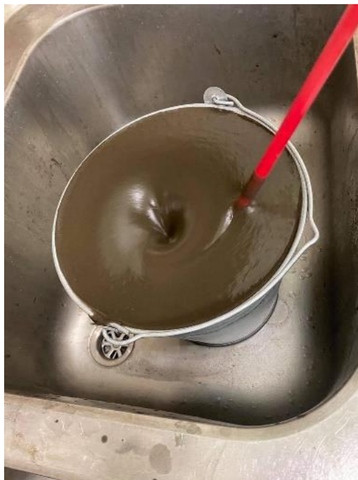
2. ábra A fölösiszap homogenizálása festékkerő fúrószárral, az addíciónálást követően. [saját kép]
