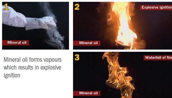
1.kép: Mérsékeltén tűzveszélyes (HLP-46 típusú) hidraulika olaj égése [6]
