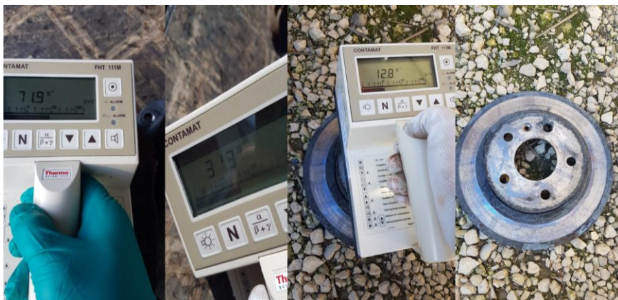
15. ábra: Az első kezelést követően a felületi szennyezettség a felére, második kezelés után a negyedére csökkent, majd a 3. kezelés után újra háttér értéket lehetett mérni, [saját szerkesztés]
