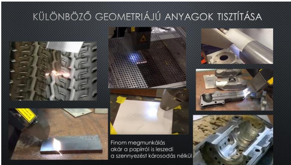
10. ábra: Különféle felületek lézeres tisztítása, [saját szerkesztés]
