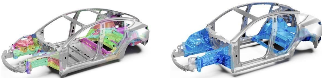
5. Ábra: Karosszéria elemek integrációja öntőprés eljárással [20]
