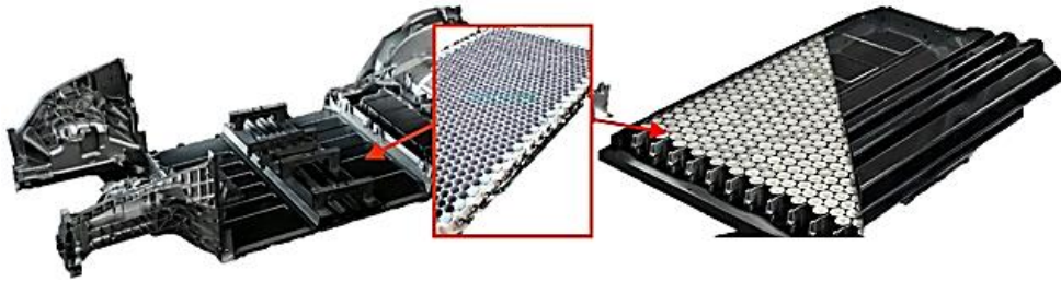
6. Ábra: Integrált energiátároló rendszer [20]
