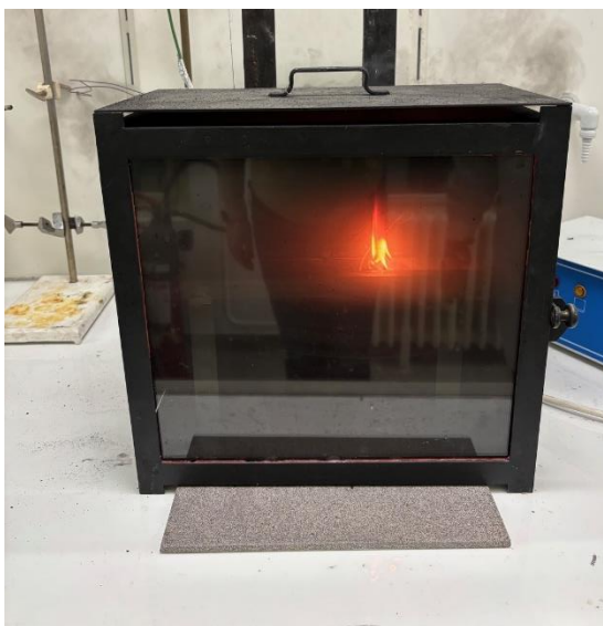
1. Ábra: Vízszintes tűzterjedés vizsgálathoz szükséges szabványos égetőkamra (Forrás: szerző tulajdona)
