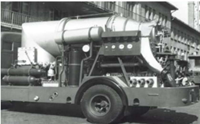
13. ábra: Szilvay-féle gázturbinás szárazoltó [27]
