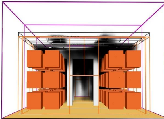
7. ábra: Raktárépületben terjedő füst láthatóságot befolyásoló hatása Forrás: Készítette [20] alapján a szerző
