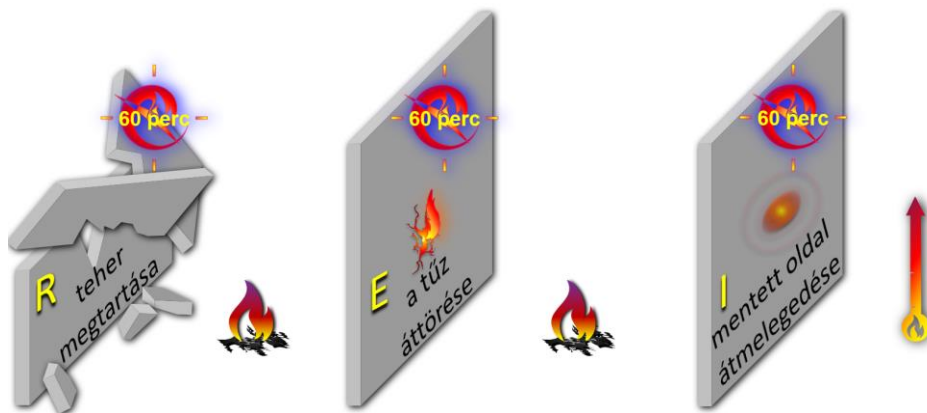
10. ábra: Tűzgátló szerkezet egyes teljesítménymutatójának alapértelmezése Forrás: Szerkesztette [23] nyomán a szerző
