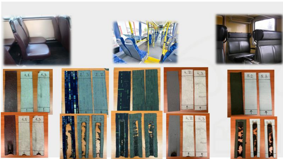
3. Ábra: A kísérletben megvizsgált minták, rendre: barna bőr ülészuzat Ikarus autóbuszból, kék-sárga szövet Credo típusú buszból, szürke ülészuzat Credo típusból, Credo padlóburkolat és zöld bőr vonatkocsi ülés (Forrás: szerzői összeállítás)
