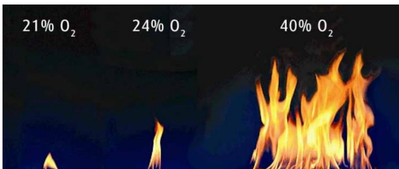
5. ábra: Oxigénkoncentráció hatása az égésre (Forrás:www.linde-gas.be [18])
