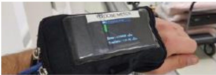
10. ábra: A virtuális dózisteljesítménymérő alkarra szerelve, így mindkét kéz szabad marad, ami megkönnyíti az árnyékolás mögötti beavatkozást, [saját szerkesztés]
