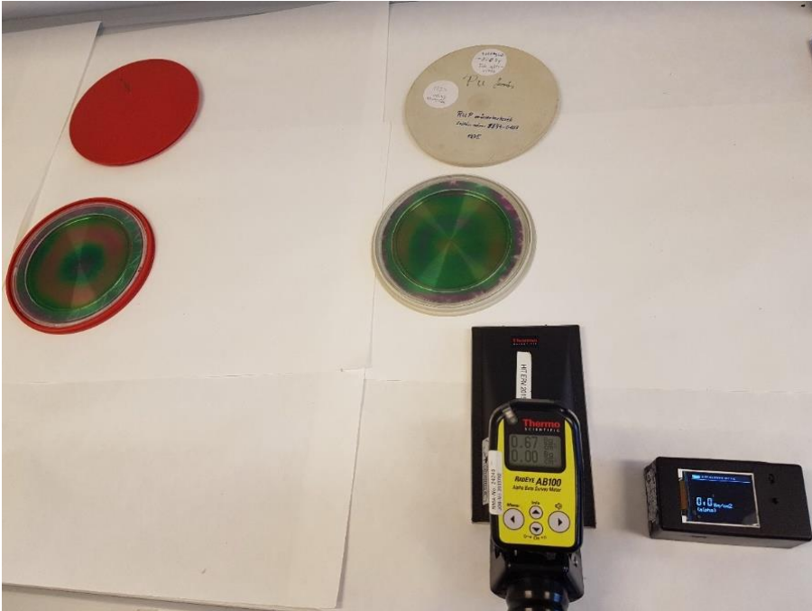
14. ábra: Thermo AB-100 valódi felületi szennyezettség mérő (alsó érték a kijelzőn) és a virtuális felületi szennyezettség mérő alfa háttér mérése (valós mérőeszköznél az alsó érték az alfa szennyezettség) ( 0,00 \text{ Bq/cm}^2 ) a ^{239}\text{Pu} etalon sugárforrások mellett, [saját szerkesztés]
