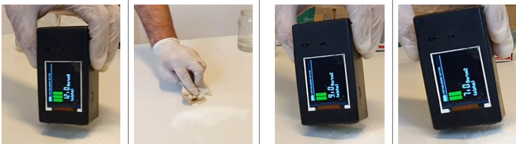
18. ábra: A „mért” virtuális felületi szennyezettség értékek csökkenése a dekontaminálási fázisokat követően, [saját szerkesztés]
