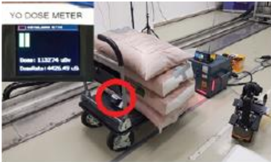
9. ábra: Az imitált besugárzó berendezésből kivérelt virtuális forrás, virtuális dózisteljesítmény mérése, 50 cm vastag műtrágya mögött, [saját szerkesztés]
