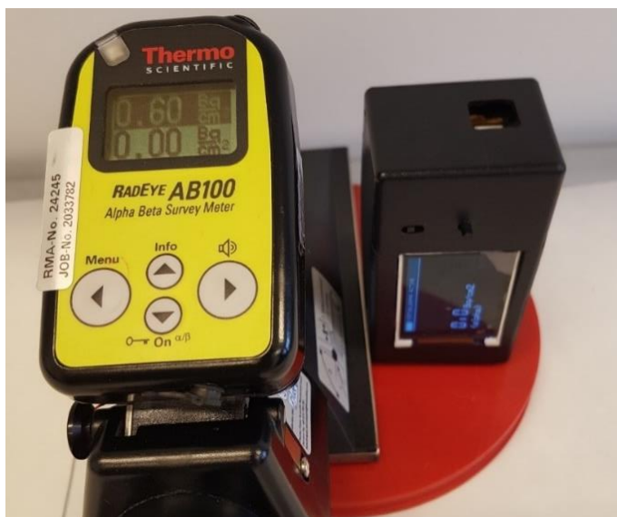
16. ábra: A valós (bal) vs. virtuális (jobb) felületi szennyezettség mérő „mért” alfa felületi szennyezettség értéke (valós mérőeszköznél az alsó kijelzett érték az alfa szennyezettség) a letakart etalon forrás esetén, mindkét esetben 0,00 \text{ Bq/cm}^2 , [saját szerkesztés]
