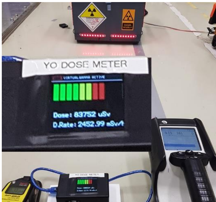
7. ábra: Az imitált besugárzó berendezésből kivezérelt virtuális radioaktív forrás, látható, hogy a valós dózisteljesítmény mérők (jobb és baloldali készülék) értékei nem emelkednek, de a virtuális dózisteljesítmény mérő (középső készülék) értéke több nagyságrendet ugrik, [saját szerkesztés]
