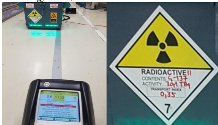
6. ábra: Az izotóp azonosító készülék az imitált besugárzó berendezésen lévő felirattal megegyezően ^{137}\text{Cs} -et érzékel (felső ábra), az alsó ábrán az imitált besugárzó berendezés címkézése látható (izotóp, aktivitás, Transzport Index), [saját szerkesztés]
