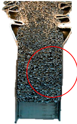
10. Ábra: Zömületlen állapotban maradt abszorber a crashbox belsejében részleges gyűrődés esetén [27]
