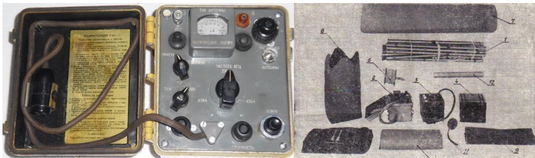
3. ábra: Az R-851 rádióállomás kezelőfelülete és teljes üzemi készlete. A szerző szerkesztése [12] és [13] alapján
