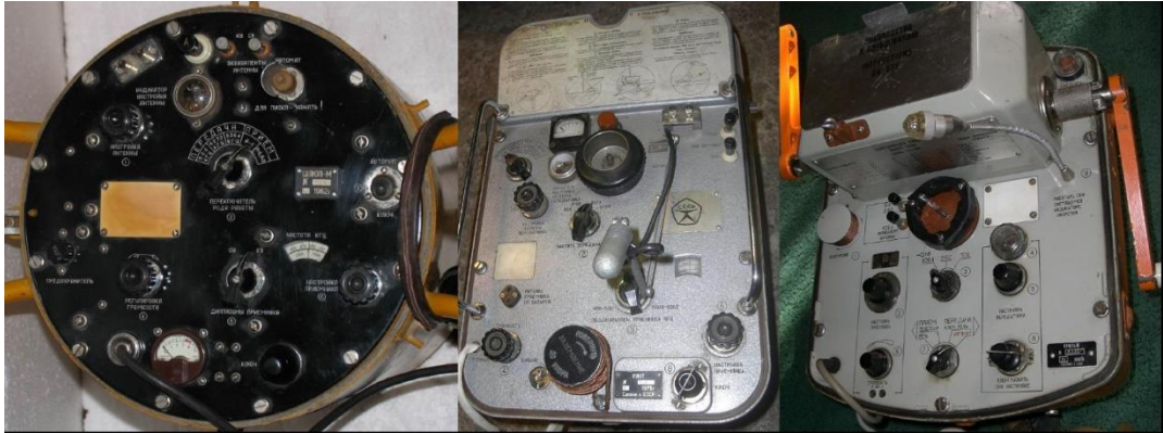
8. ábra: Tengerészeti vészrádiók kezelőfelületei, balról-jobbra: SLJUP-M; PLOT; PRIZIV. A szerző szerkesztése [41] alapján
