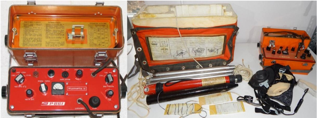
7. ábra: Az R–861 rádióállomás kezelőfelülete és teljes üzemi készlete. A szerző szerkesztése [31] és [32] alapján
