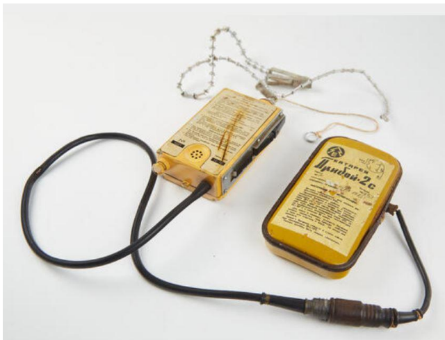
5. ábra: Az R–855UM rádióállomás a PRIBOJ–2Sz áramforrással [20]
