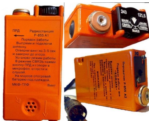
6. ábra: Az R-855A1 rádióállomás és az üzemmód-választó kapcsolója. A jobb alsó sarokban az R-855A2 vészjeladó látható. A szerző szerkesztése [26] alapján
