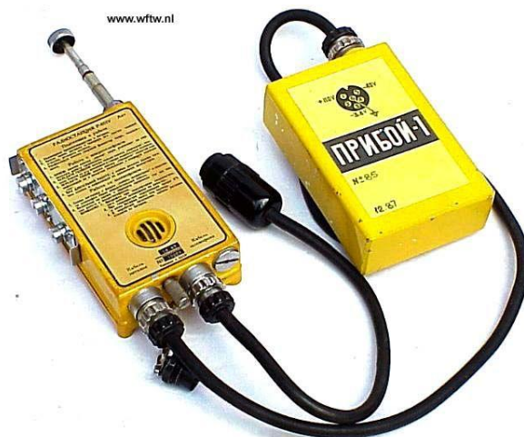
4. ábra: Az R-855U rádióállomás a PRIBOJ-1 áramforrással és a kábelekkel [15]
