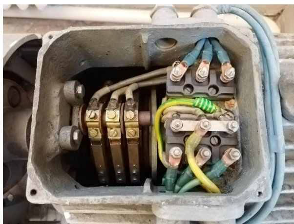
3. ábra Közeli felvétel a csúszógyűrűkről.
