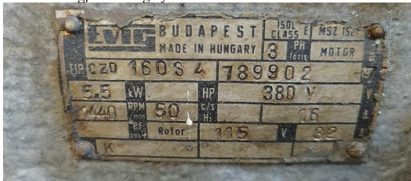
1. ábra Csúszógyűrűs aszinkron motor adattáblája.
