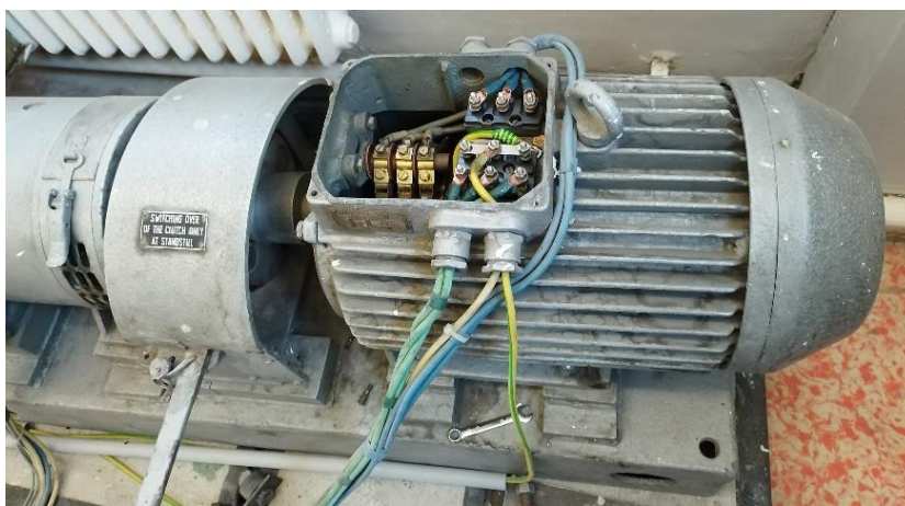
2. ábra Csúszógyűrűs aszinkron motor felső burkolat levétele után.
