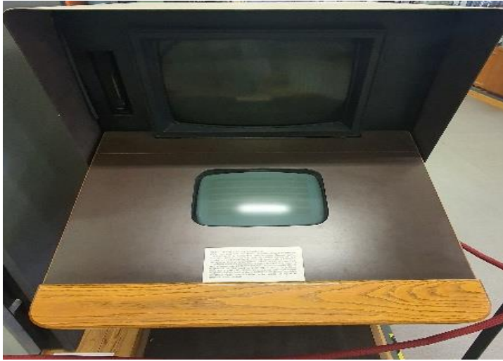
3. Ábra: Telesis grafikus munkaállomás (Angliai modell Elektronikus Mérőkészülékek Gyára, 1985): A munkaállomás (1980) a CAD-CAM szoftverek és a digitális plotterek segítségével precízen kezelte a képi adatokat, lehetővé téve azok manipulálását, hogy az információk rejtett módon kerüljenek beágyazásra a digitális képekbe, MKKM Műszaki Tanulmánytár, saját kép
