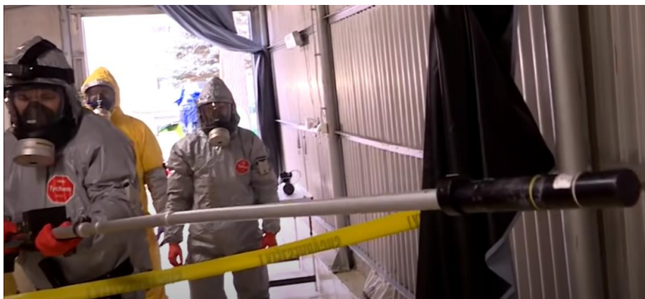
3. ábra: Sugárforrás-felderítéshez használt dózisteljesítmény-mérő készülék (az említett rúdra elhelyezett GM szonda), [4]
