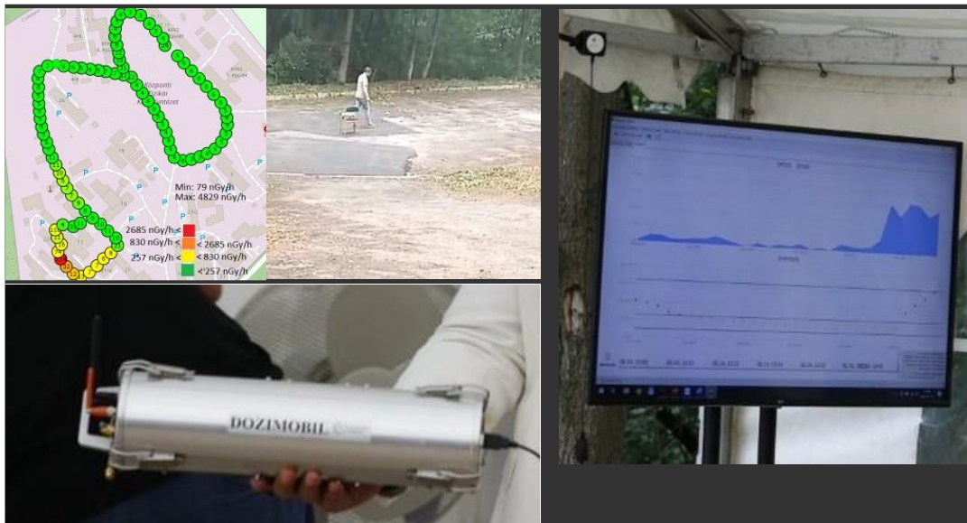
13. ábra: A HUN-REN EK által fejlesztett „DoziMobil” dózisteljesítmény térkép megjelenítésre alkalmas felderítő mérőeszköze, (saját szerkesztés)
