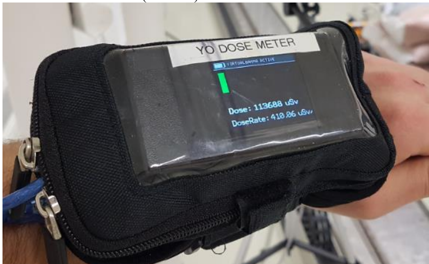
14. ábra: A virtuális radioaktív rendszer „dózisteljesítmény mérő” egysége, (saját szerkesztés)
