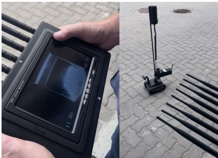
19. ábra: Az UGV-re rögzített detektor és az analóg jelátvitel, (saját szerkesztés)
