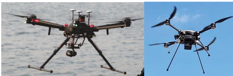
4. ábra: Sugárforrás felderítő drónok, [6], [7]
