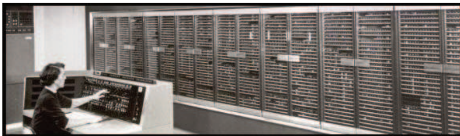
2. ábra: The IBM Naval Ordnance Research Calculator (1954), az első „szuperszámítógép” [9]. Az IBM NORC korának a legerősebb számítógépe volt és másodpercenként 15000 műveletet tudott végrehajtani. A fő memóriájában 2000 64 bites szó volt, ami 16 kilobájtnak felel meg. Az információs adatokat külön teremőr vigyázta...
